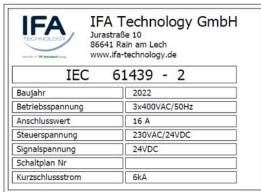
Abbildung 1 Typenschild (Beispielabbildung) im Hauptschrank
