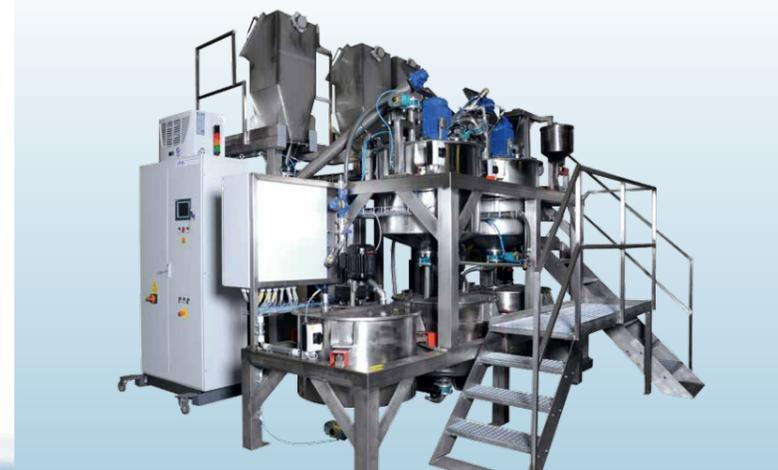
Unsere Anlagen können je nach Anwendung explosionsgeschützt (Gas/Staub) oder säurefest ausgeführt sein. Passend dazu liefern wir für Sie maßgeschneiderte Rührwerke – zum Homogenisieren, Emulgieren, Begasen, Vermahlen, Suspendieren, Dispergieren oder Mischen und Lösen Ihrer festen und flüssigen Stoffe.
